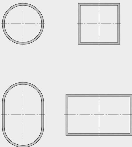
Querschnitte für Flanschbefestigung
